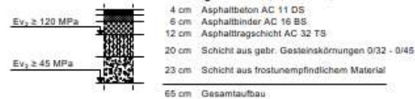
Deckenaufbau gem. RStO 12 Belastungsklasse 3,2, Tafel 1, Zeile 1
