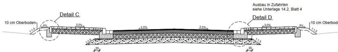
Deckenaufbau Fahrbahn gem. RStO 12
