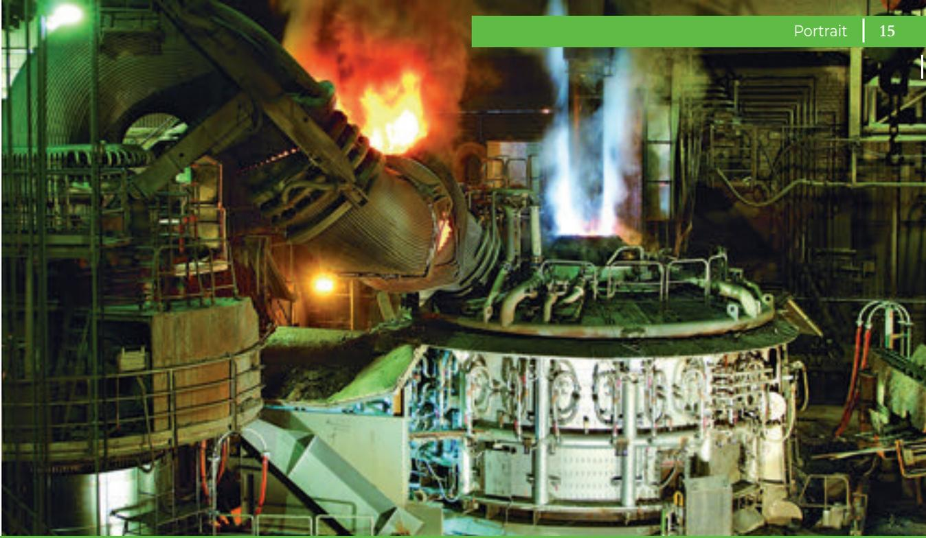
einem Pfannenofen sowie einer Vakuumanlage veredelt, wird auf der Stranggießanlage vergossen. Im Walzwerk ermöglichen Präzisionswalzeinheiten die Fertigung extrem toleranzgenauer Stabstähle. In der Wärmebehandlung erhält das Material die geforderten Werkstoffeigenschaften – alles genau nach Kundenwunsch.
