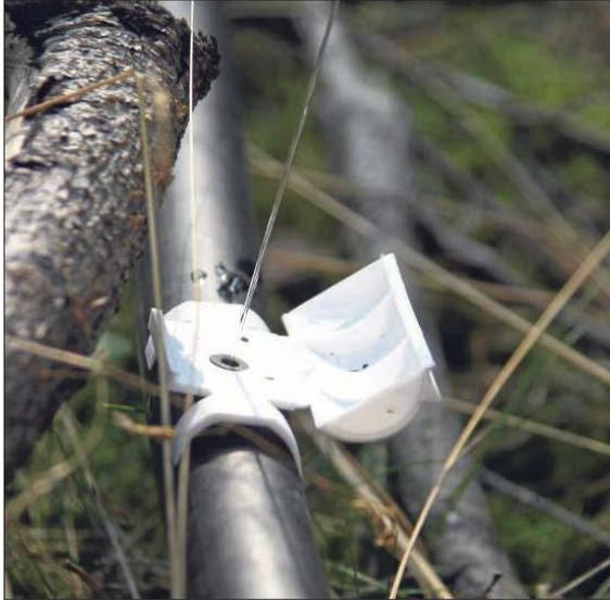
Normalerweise sind die Klappen nicht geöffnet: Mit Hilfe von 4200 Düsen wird das Wasser langsam im Wald verteilt, denn auch wenn die Klappen geschlossen sind, kann das Wasser austreten. Fotos: Nolting
