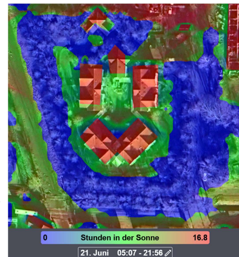
Abbildung 7: Expositionsdauer gegenüber Sonnenstrahlung am 21. Juni (Sommersonnenwende mit Sonnenhöchststand). Je roter die Flächen, desto länger die Bestrahlungsdauer. Blau gefärbte Flächen (hier zumeist unter Bäumen) liegen hingegen lange im Schatten. Quelle: ShadeMap, 2025.
